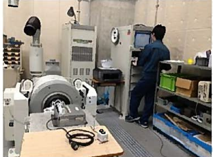
X方向の共振点検索試験実施、共振点なしと判明
