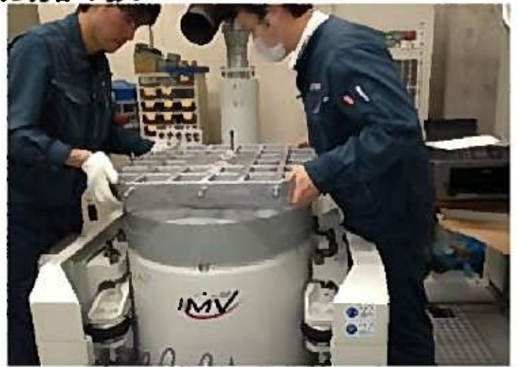
垂直方向試験架台を固定
