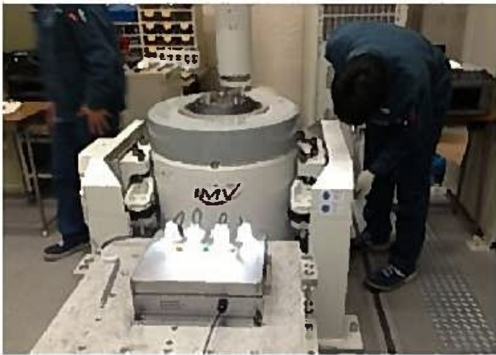
試験機を垂直方向に切替作業
