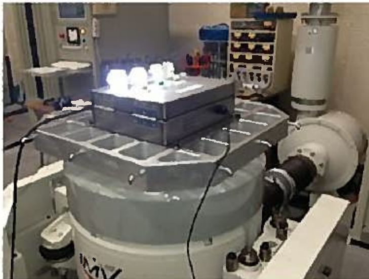
共振点検索試験 (5~33 Hz、リニアスイープ)
